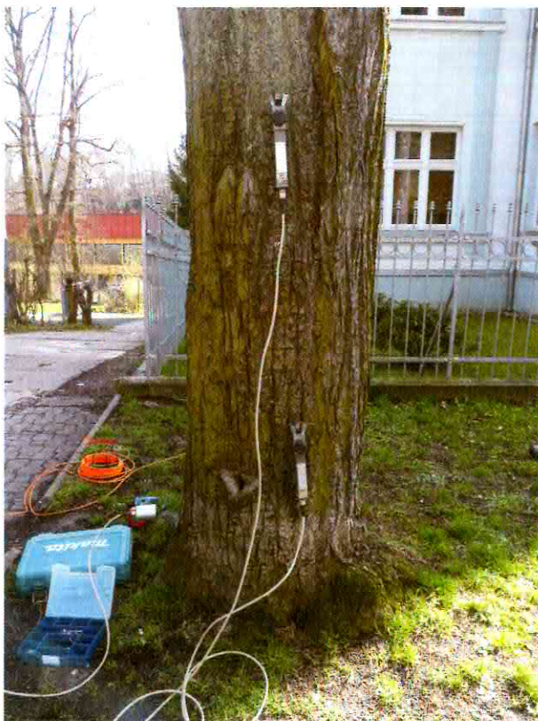
Obr. 7-8: Pozice přístrojů na kmeni při tahové zkoušce
