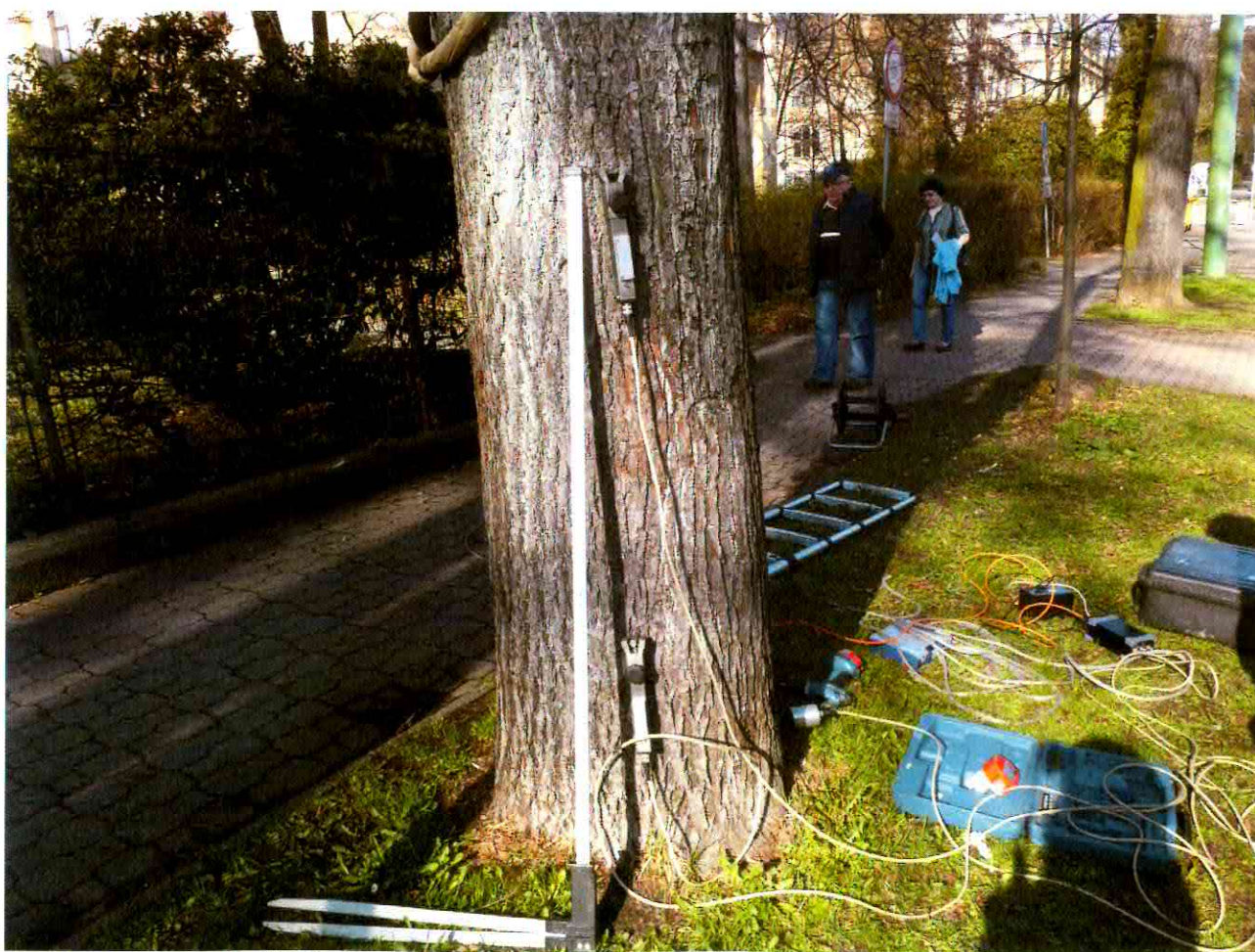
Obr. 22: Pozice přístrojů při tahové zkoušce
