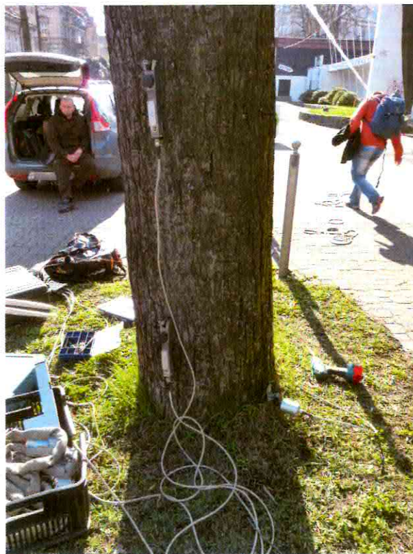
Obr. 26: Pozice přístrojů při tahové zkoušce
