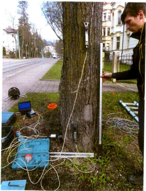
Obr. 12: Pozice přístrojů při tahové zkoušce
