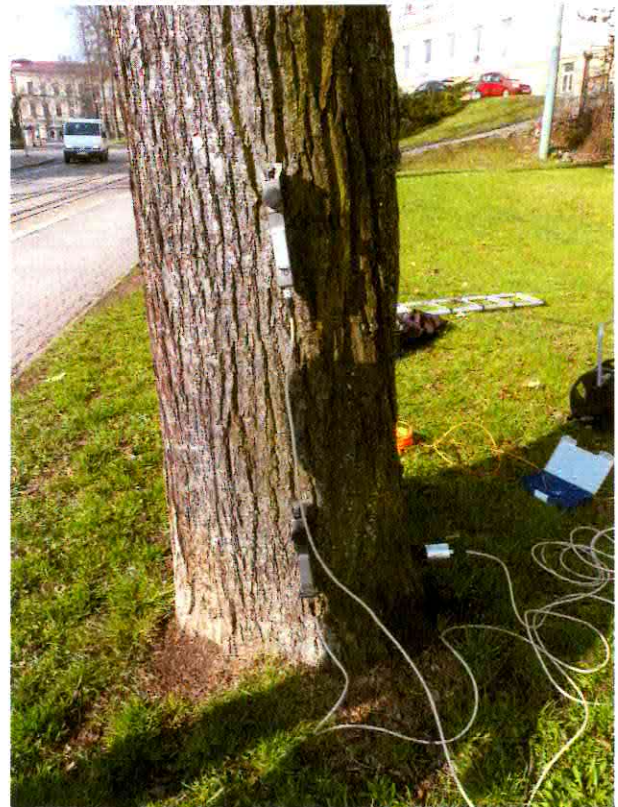
Obr. 30: Pozice přístrojů při tahové zkoušce
